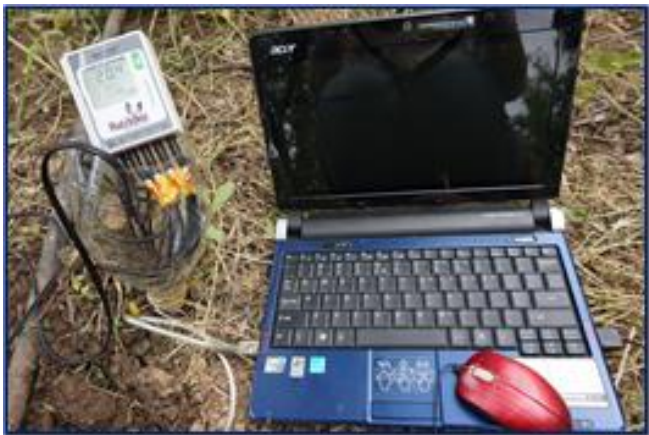
Fig. 21. Monitorizarea stării de umiditate a solului cu ajutorul înregistratoarele de tip WatchDog seria 1000
