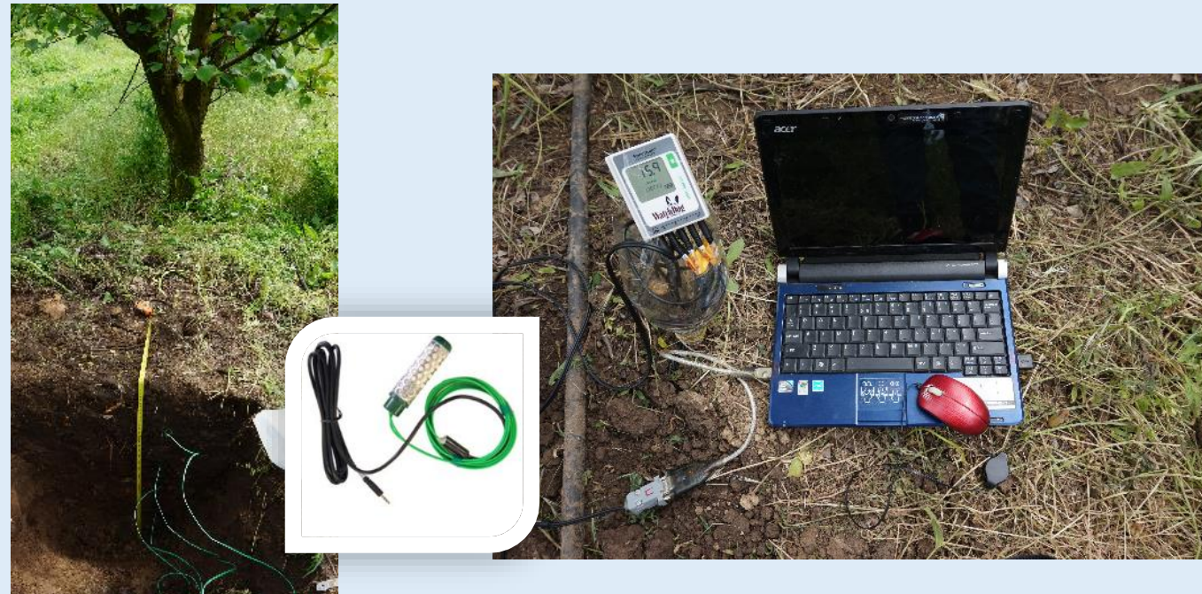
Fig. 34. Montarea senzorilor de umiditate în profilul de sol și transferul datelor într-un laptop pentru prelucrare periodică
