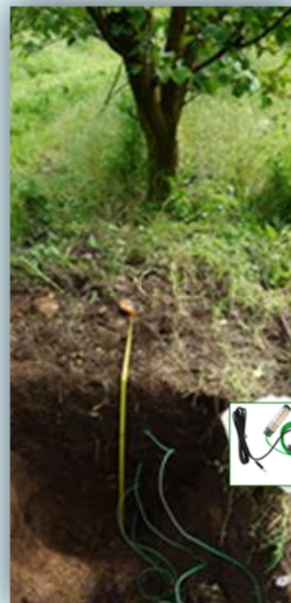
Sistem de monitorizare potențial de apă din sol (Senzori de tip Watermark, datalogger WatchDog seria 1000 și laptop)
