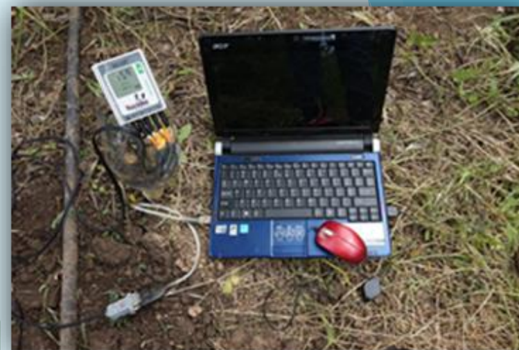
Sistem de monitorizare potențial de apă din sol (Senzori de tip Watermark, datalogger WatchDog seria 1000 și laptop)
